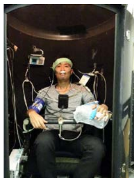
◀図4 ゴンドラ内の様子（計測機器を装着した状態） 装着機器 ※（）内は計測項目 ・心電図計（心電図波形・脈拍数） ・マンシット血圧計（血圧） ・連続血圧計（連続血圧・動脈圧波形） ・パルスオキシメーター（末梢動脈血酸素飽和度） ・カブノメーター（呼気終末二酸化炭素濃度・呼吸数） ・経頭蓋ドブラ血流計（脳血流速度・流速波形） ・近赤外分光計（局所血液酸素飽和度）
